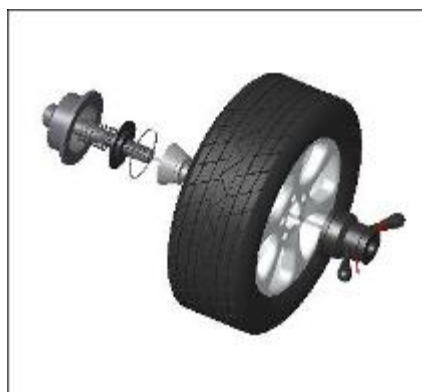
Основной вал – соответствующий конус (широким диаметром вовнутрь) —колесо— быстрозажимная гайка
