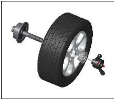
Основной вал-колесо— соответствующий конус (малым диаметром вовнутрь) — быстрозажимная гайка
